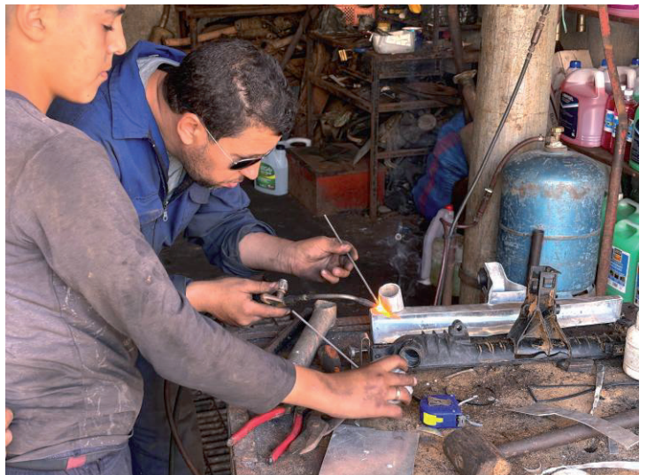
Reparatie radiator inlaet Zagora Marokko.
